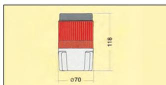
Le dimensioni di ingombro non cambiano indipendentemente dal tipo di segnalatore che viene utilizzato (luce fissa, lampeggiante, flash o led).
