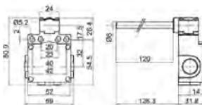
Coppia Min. Azionamento 0,12 Nm (0,60 Nm ⊖)
